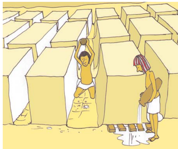
FIGURE 2 Carrières en tranchées. Usinage par percussion. Dessin : J.-P. Petit.
